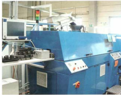
Von der Richtstation läuft das Material in die Wirbelstrom-Rissprüfung. Mit zwei mal acht Frequenzen deckt sie ein breites Fehlerspektrum ab.
