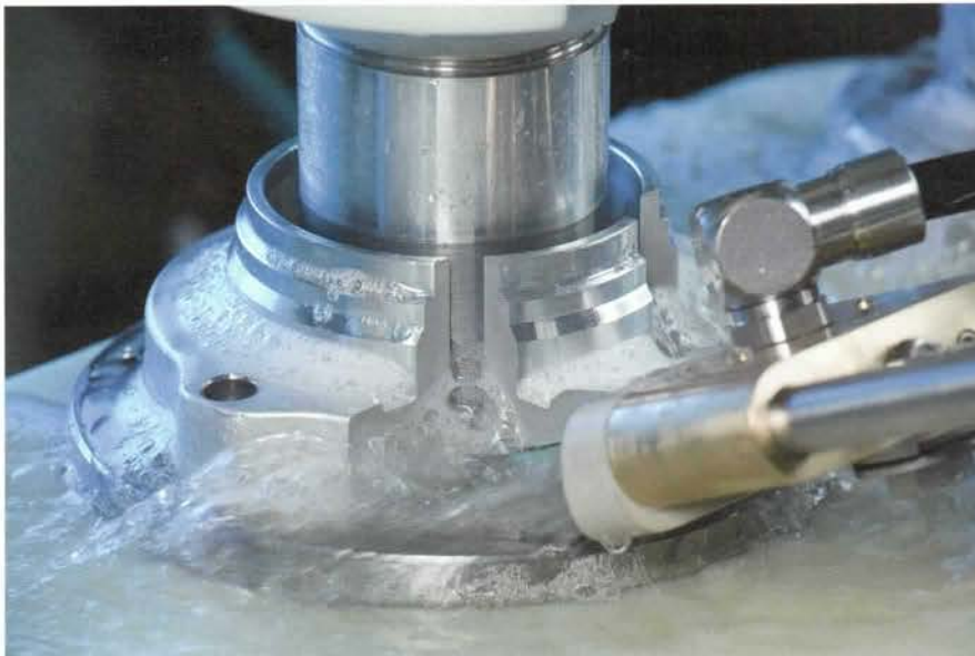
1 Beim ECM-Verfahren wird ohne mechanische oder thermische Beeinflussung nur dort entgratet, wo wirklich ein Materialabtrag gewünscht wird
