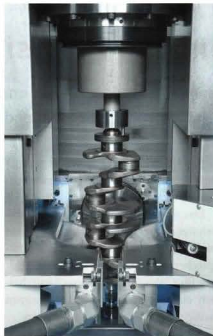
3 Synchro-Stützschleifen von Hauptlagern an einer Kurbelwelle
