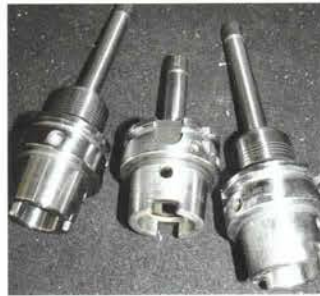
Auf Grund der beengten Platzverhältnisse durch die Höhe der Spannpratzen wird mit der schlanken Ausführung von Centro P gearbeitet.
