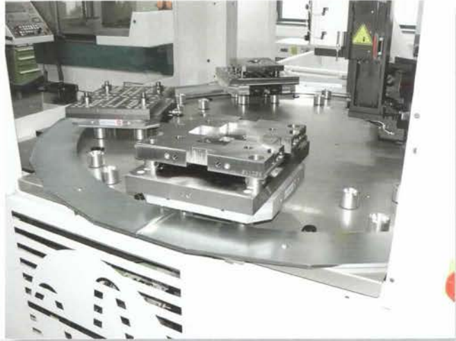
Bild 4: Ausgestattet mit 10 UPC-Paletten hat man bei Gindele begonnen die Maschine tagsüber zu rüsten und in die Nacht laufen zu lassen
