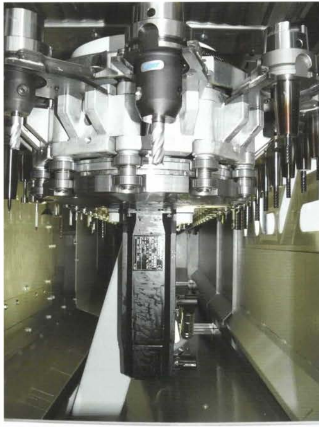
Bild 2: Der Werkzeugspeicher ist mit 80 Plätzen ausgerüstet. Für die optional zur Verfügung stehenden 200 Speicherplätze war der Platz nicht da
