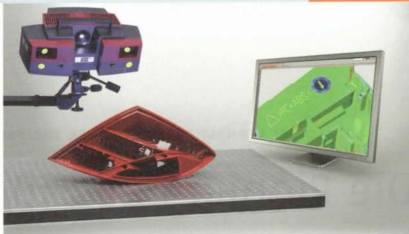
**Inspektion mit Atos Triple Scan:** Diese erfolgt hier an einem Spritzgusswerkzeug und einem Kunststoff-Spritzgussteil. Dabei ermöglicht die fertigungsnahe optische Messtechnik die Kontrolle einzelner Bearbeitungsstufen bei der Werkzeugherstellung sowie am produzierten Spritzgussteil. So lassen sich Fehler rechtzeitig erkennen, bevor weitere und teure Fertigungsschritte folgen.
