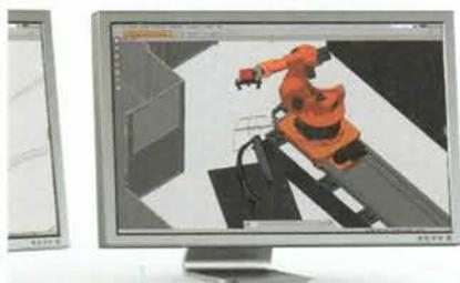
**Inspect Professional Software:** Diese ist für die computergestützte Messung und Inspektion vielfach gerüstet. Die Inspektionsmerkmale, die bereits am Konstruktionsdatensatz (CAD) anhaften sind problemlos importier- und auswertbar. Auf diese Weise bleibt die Inspektion in der digitalen Kette, der fehleranfällige Weg über die analoge 2D-Zeichnung wird damit vermieden.
