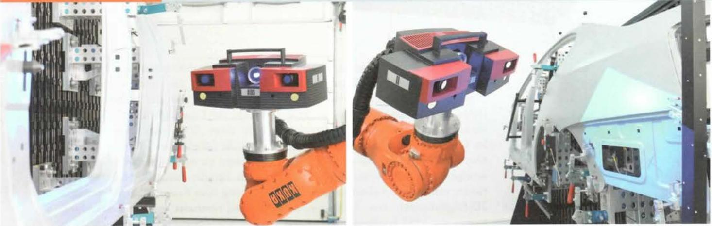
**Automatisierte Messzellen:** Die Messdatenerfassung lässt sich bereits im Produktionsumfeld mit Dreh-, Schwenk- und Verfahr-Einheiten optimal automatisieren. Bei größeren Bauteilen wird der Sensor in Roboter messzellen integriert. Bei der Datenauswertung gibt es keinen zeitlichen Unterschied zwischen der Inspektion von Einfach- oder Mehrfach-Bauteilen.
