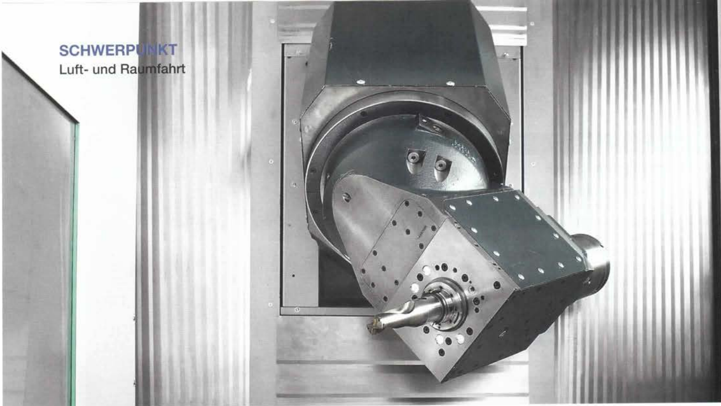
Kraftpaket: Die Schwenkkopf-Einheit Power Cutting Universal PCU 63 ist laut Heller mit 44 kW die derzeit stärkste 5-Achs-HSK63-Spindel am Markt. Bilder: Heller
