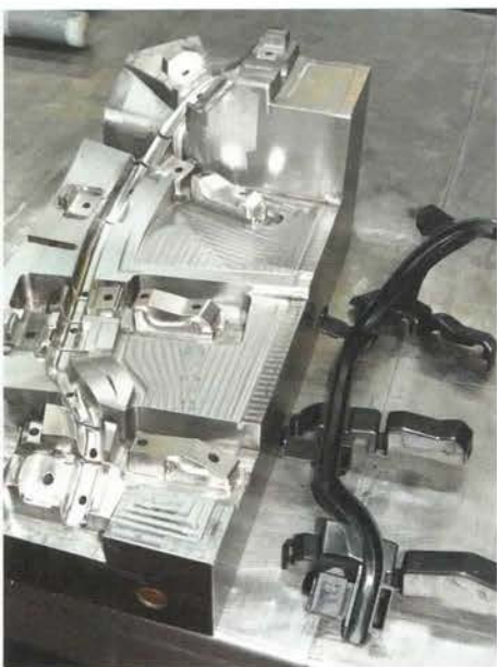
Kromberg & Schubert sucht bei Werkzeugen für Thermoplaste und Gummitteile nicht das µm. Die geforderten ein bis zwei Hundertstel Millimeter Präzision erreicht man mit den beiden Maschinen von OPS-Ingersoll jederzeit
