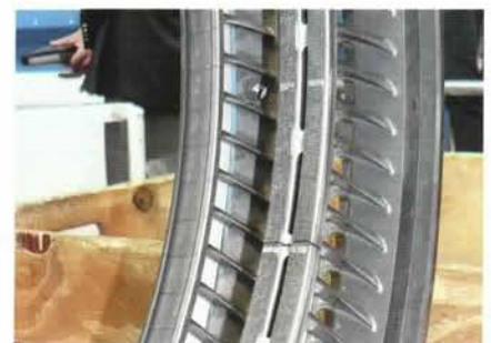
Die Gefahr beim Einschleifen der Honeycombs bestand darin, dass es zu Verstopfungen durch Schleifspäne kam. Das wiederum kann zu Zerstörungen im Triebwerk führen.
