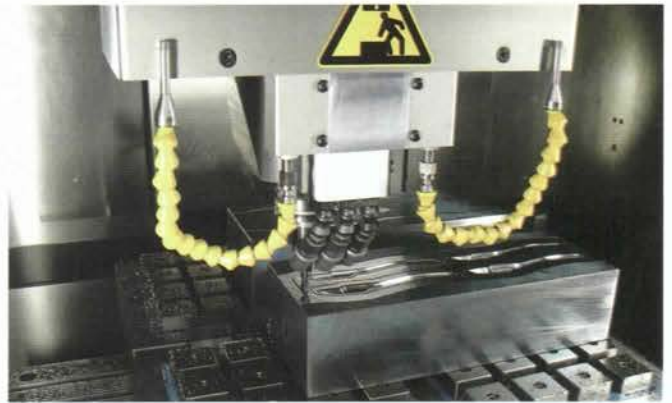
Mit 18 000 min -1 ist man zwar bei Drehzahl und Vorschub begrenzt. Bei Bronner + Martin legt man aber ohnehin mehr Wert auf Standzeit und Zuverlässigkeit.
