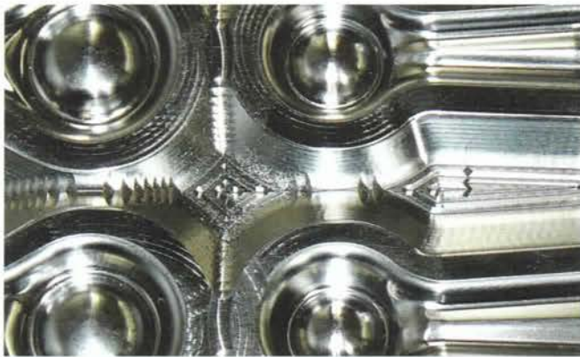
Um ein Polieren zu vermeiden, muss die Oberflächengüte bereits im Fräsprozess ausgezeichnet sein.
