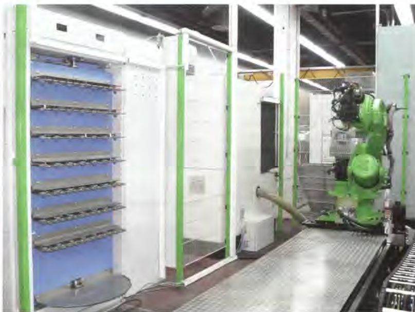
Der 6-Achsen-Roboter verfährt auf einer Linearschiene. Zudem beinhaltet Moneymaker die Be- und Entladestation und Elektroden- und Werkstückmagazine
