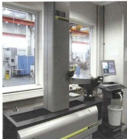
Das venturion 800 ist ausgestattet mit der Bildverarbeitungssoftware pilot 3.0 und kann Werkzeuge bis zu 1200 mm automatisch – über Chip gesteuert – vermessen.
