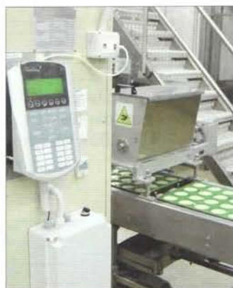
Je ein Terminal pro Backstraße erfasst Informationen zu Lauf-, Stör- aber auch Personalzeiten.
