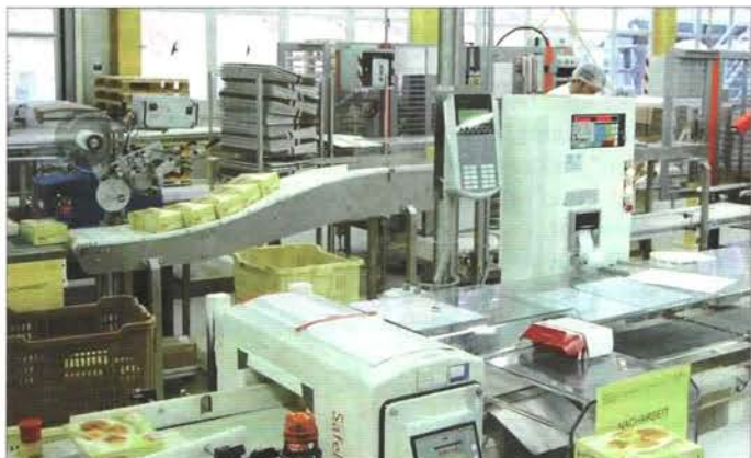
In den drei Verpackungslinien wurde die Störgründe auf die Tiefziehmaschine und den Roboter beschränkt.
